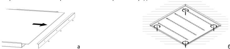
Рисунок 5 — Накладной монтаж светильника Geniled серии Офис, ЛПО.
